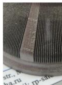
6-сурет- SLM 280 машинасында құрастырылған электр бөлігі. Қабырғалардың қалыңдығы 0,35 мм. "NAMI" FSUE ұсынған
