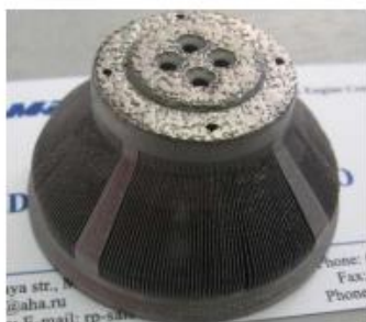
6-сурет- SLM 280 машинасында құрастырылған электр бөлігі. Қабырғалардың қалыңдығы 0,35 мм. "NAMI" FSUE ұсынған
