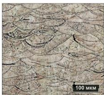
а, b – SL Campanelli деректері бойынша [4]; c, d – профессор Н.Г.Кольбасников бойынша.. SPbSPU ұсынған 2-сурет- DMLS технологиясы бойынша алынған 1.2709 мартенситті-қатайтатын болаттан жасалған үлгінің құрылымы
